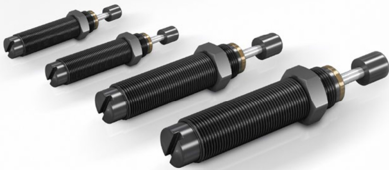
Bild 3: Selbsteinstellende Kleinstoßdämpfer der Serie MC5 bis MC75 von ACE mit Gewindegrößen von M5x0,5 bis M12x1 für den Abbau effektiver Massenkräfte zwischen 0,5 kg und 72 kg.
